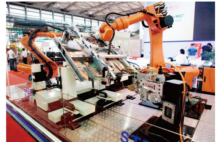
汽车前底板柔性点焊
