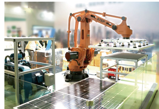
太阳能电池板搬运
